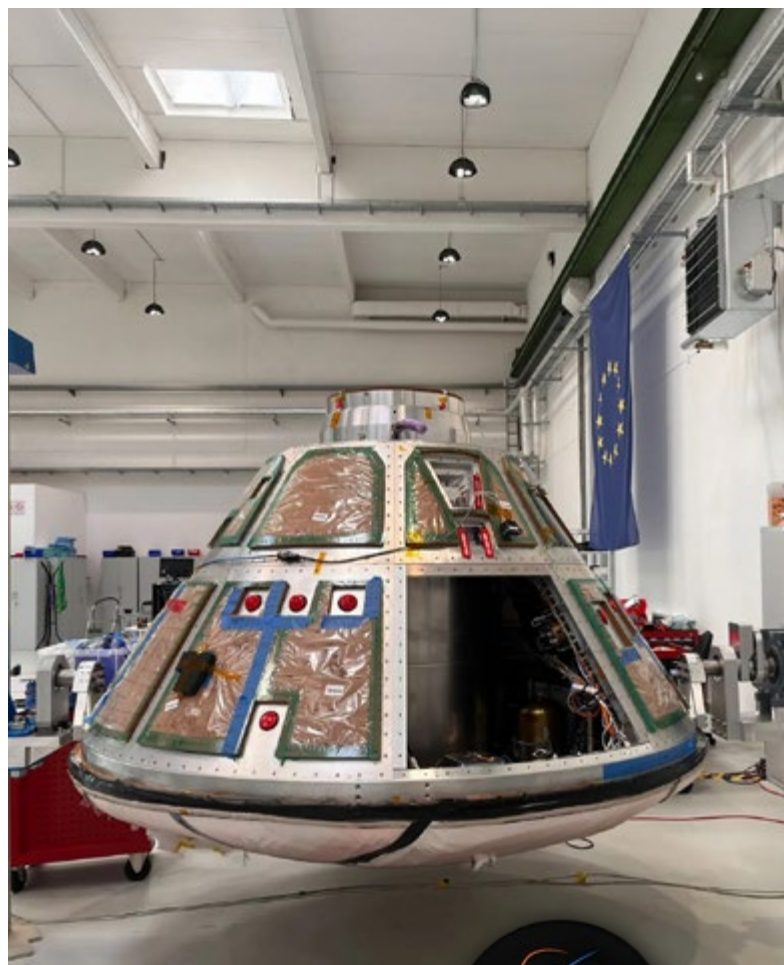
Nyx orbital rymdkapsel är utvecklad av The Exploration Company. I framtiden förväntas den docka med rymdstationer och återföra upp till 3 000 kg last tillbaka till jorden. Nyx är återanvändbar och kan lastas på i omloppsbana för att utöka sina uppdrag. Foto: ©The Exploration Company
